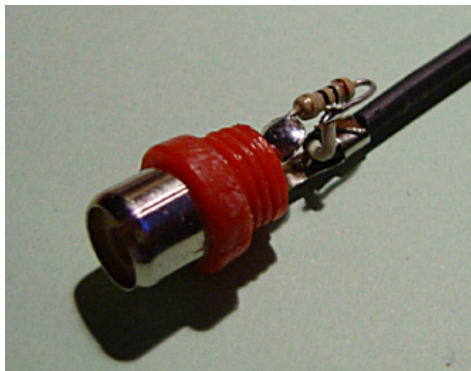
Colocación de la resistencia en el interior de un RCA Hembra.
